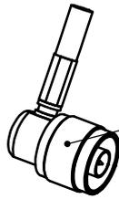
HF-Anschluss N(m)-Winkelstecker mit RG223-FRNC-Koaxialkabel / RF connection N(m) angle plug with RG223 FRNC coaxial cable
