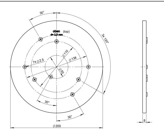
Zur fachgerechten Erstellung des Bohrbildes auf dem Fahrzeugdach.
